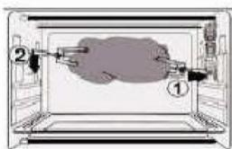
Inserte las horquillas del asador de espada en el orificio del asador de espada, y seguidamente instale la bandeja recolectora debajo del asador de espada
