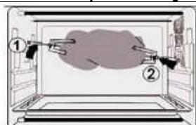
Verwijder de vorken van het draaispit met behulp van het handvat van het draaispit, verwijder vervolgens de braadslede
