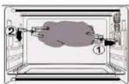
Breng de vorken van het draaispit in in de opening van het draaispit, plaats vervolgens de braadslede onder het draaispit
