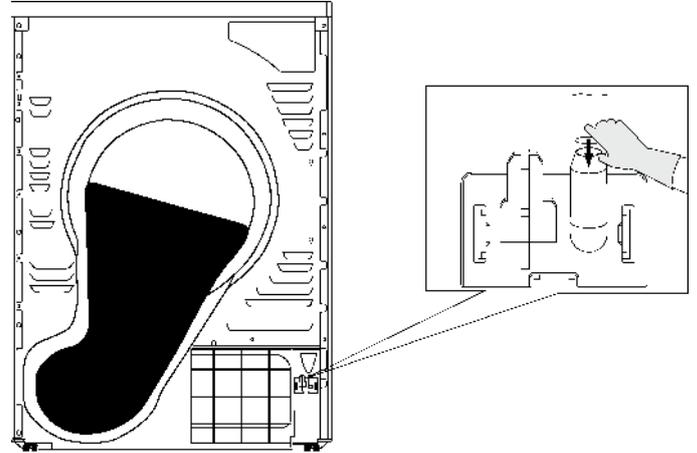
2. Insérez une extrémité du tuyau d'évacuation fourni dans le connecteur de tuyau.
