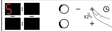
Con una potencia > 5, una rápida doble pulsación del botón + permite acceder a la potencia 9.
