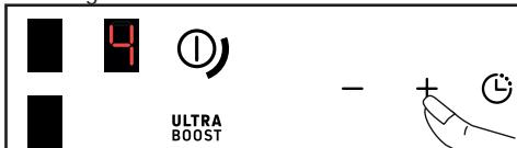
Bei einer Leistung < 5 ermöglicht ein schneller Doppeldruck auf die +-Taste den direkten Zugriff auf die Leistung 5.
