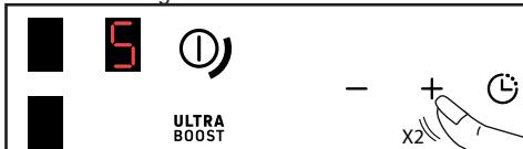
Bei einer Leistung > 5 gelangen Sie mit einem kurzen Doppeldruck auf die + Tasten direkt in die Leistung 9.
