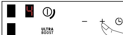
Con una potencia < 5, una rápida doble pulsación del botón + permite acceder directamente a la potencia 5.
