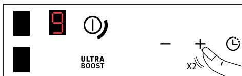
Das Drücken der Taste **ULTRA BOOST** ermöglicht den Zugriff auf die maximale Leistung.
