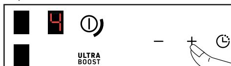
Avec une puissance < à 5, un double appui rapide sur la touche + permet d'accéder directement à la puissance 5.
