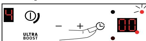
Die Timer-Nullen blinken zusammen mit der LED für die Timer-Einheiten und der LED für den aktiven Fokus. \* Je nach Modell
