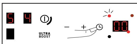
Die Einstellung erfolgt anschließend durch Drücken auf + oder -
