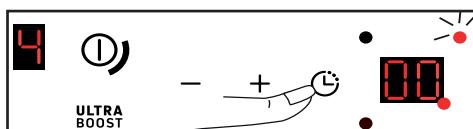
De timer nullen knipperen samen met de timer eenheden LED en de actieve focus LED.
