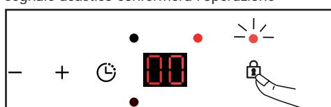
Il display delle zone di cottura in funzione mostra ora alternativamente il simbolo di potenza e il simbolo di blocco .
