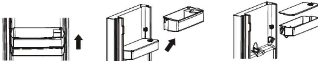
2. Tras la limpieza, vuelva a colocar el depósito de agua, la tapa y el compartimento de puerta como se indica a continuación.
