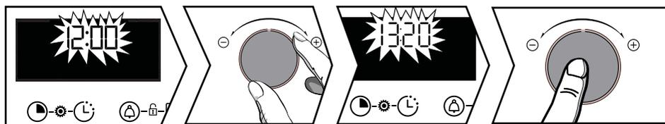
À la mise sous tension l'afficheur clignote à 12:00.
