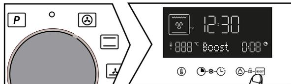
Appuyez sur la touche **Boost** pour une montée en température rapide. L'indicateur de température
