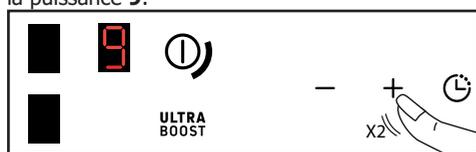
Un appui sur la touche **ULTRA BOOST** permet d'accéder à la puissance maximale
