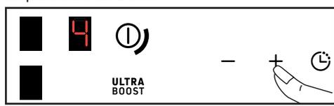
Avec une puissance < à 5, un double appui rapide sur la touche + permet d'accéder directement à la puissance 5.
