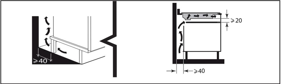
ou au-dessus d'un four encastrable, respectez les dimensions notées sur les illustrations afin d'assurer une sortie d'air suffisante à l'avant.
