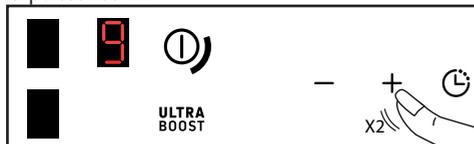
Un appui sur la touche **ULTRA BOOST** permet d'accéder à la puissance maximale
