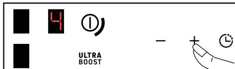
Avec une puissance < à 5, un double appui rapide sur la touche + permet d'accéder directement à la puissance 5.
