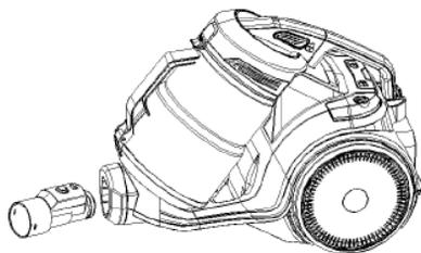
2. Pour connecter le tuyau et du tube d'extension : Tenez le connecteur du tuyau et insérez-le dans le plus grand trou du tube.
