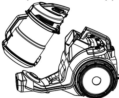
2. Placez le bac à poussière au-dessus de la poubelle, appuyez sur le bouton de déverrouillage pour ouvrir le couvercle inférieur du bac à poussière, et la saleté et la poussière tomberont dans la poubelle.
