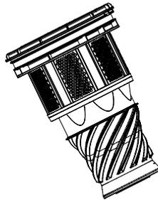
3. Ouvrez le couvercle du bac à poussière et retirez le couvercle du filtre HEPA, puis retirez le filtre HEPA. Tapotez-le pour enlever la poussière. Rincez-le sous l'eau courante si nécessaire.
