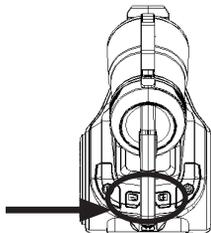
\*Vous pouvez également réduire rapidement la puissance d'aspiration en agissant sur le régulateur de flux d'air présent sur
